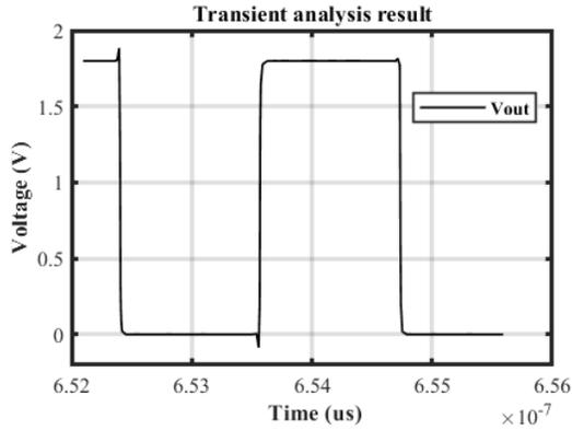
(a) Transient output waveform;  $D \simeq 50\%$ ;
